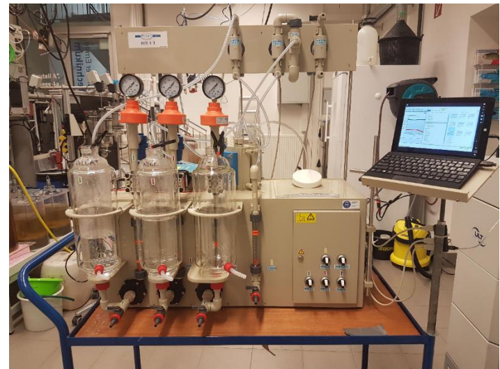
ED- Anlage im IWR Technikum
